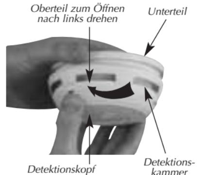
**Zum Testen der ordnungsgemäßen Funktion empfehlen wir den Einsatz eines Prüfgases. Nach einer Detektion ist der Melder 5 Min. lang gesperrt. Erkennt der Detektionskopf nach Ablauf dieser Zeit weiterhin Rauch, so wird erneut Alarm ausgelöst.**
